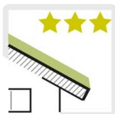
Интенсивные зеленые крыши имеют минимальную глубину шесть (6) дюймов и представляют собой слоистую систему, содержащую питательные среды, гидроизоляционную мембрану, дренаж и передовые ирригационные компоненты. На интенсивной зеленой крыше могут расти почвопокровные растения, кустарники и даже деревья, и поэтому такая кровля требует усиленной конструкционной опоры и обслуживания по сравнению с экстенсивными зелеными крышами.
