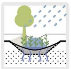
Биосвейл - это траншея с растительностью и проницаемым дном, под которым проходит дренажная труба, заполненная гравием в слое геотекстиля. Он позволяет хранить, дренировать и транспортировать дождевую воду, одновременно способствуя повышению биоразнообразия и качества жизни.
