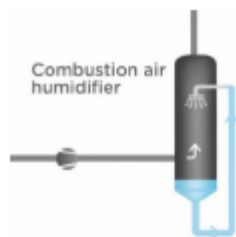
Рисунок 12: Увлажнитель воздуха сгорания, в котором вода, нагретая низкотемпературным источником, испаряется в поток воздуха сгорания.
