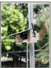
Ginagamit ang air quality monitor upang masukat ang level ng pollutant sa hangin.
